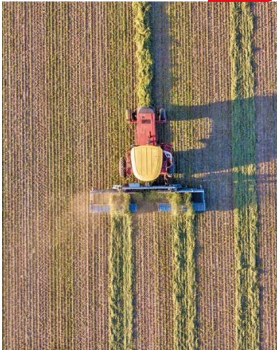
Cabezal hilerador, agrupador e invertidor de hileras trabajando.
